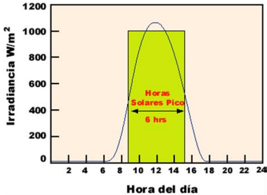
Ilustración 17 Distribucion de Energia producida en el panel durante el dia
